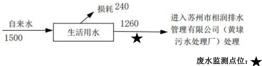
图 2-1 本项目实际水量平衡图（单位 t/a）
