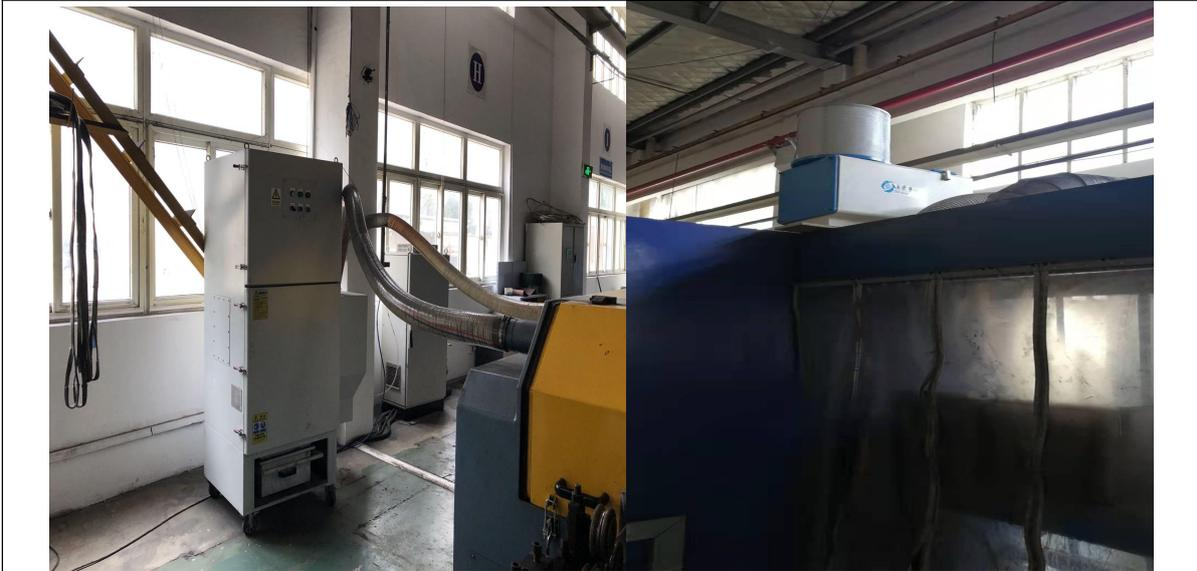
图 3-2 移动烟尘收集装置（左）、油雾净化器（右）
