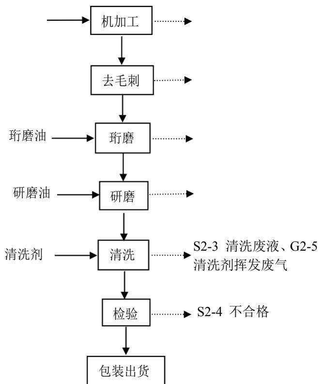
图 4.2 生产工艺流程图
