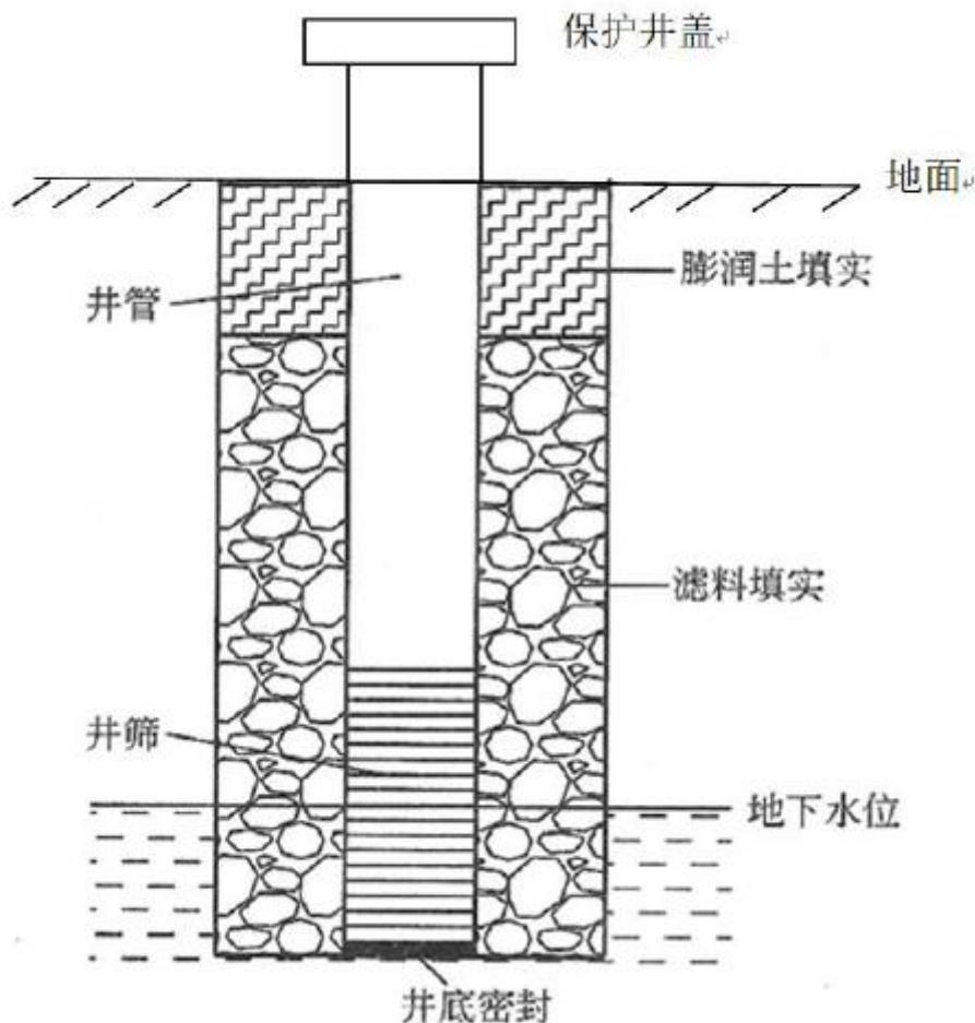
图 7.1 地下水监测井结构示意图
